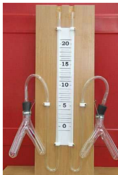
Рис. 19. Прибор для определения скорости химических реакций
